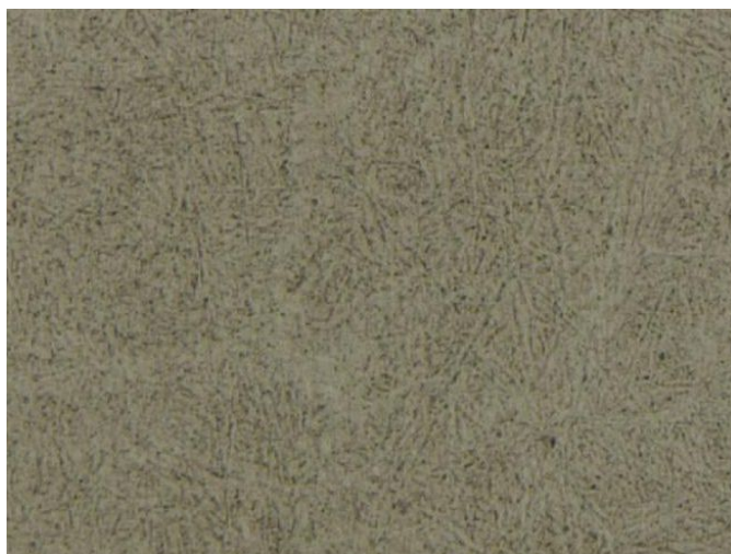
Рис. 1. Микроструктура образца из стали 20Х3Н3МФБА после термической обработки, x500
