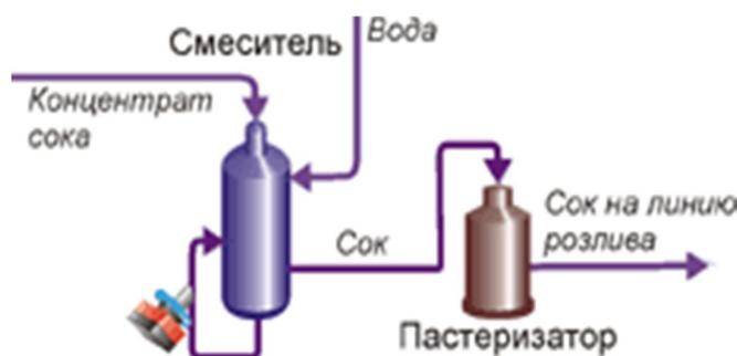
Рис. 5 Применение рефрактометров в производстве соков
